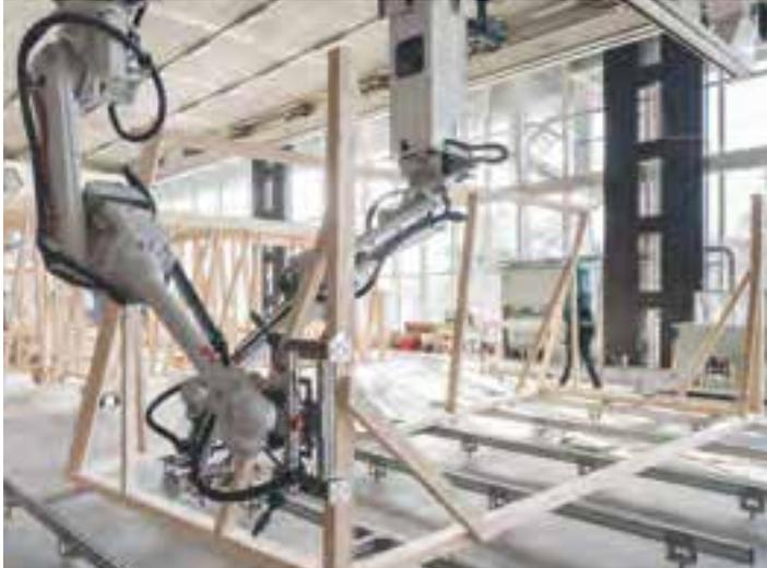
Die beiden kooperierenden Roboter positionieren die Holzbalken anhand des digitalen Modells präzise im Raum ohne zu kollidieren.
