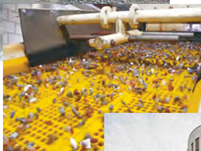
Nassaufbereitung im Kieswerk. Aus dem ehemaligen Backstein des «Steinbock» wurde gewaschenes Granulat und damit wieder ein Baustoff.
